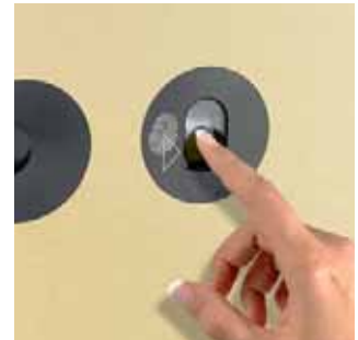
METRA-Schließsystem mit zentralem Terminal: Die Öffnung des Faches erfolgt am zentralen Terminal – und zwar entweder mit dem Datenträger oder mittels des Fingerabdruckes durch einen Biometrie-Leser.
