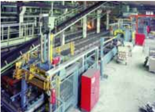
HWS-Hochdruckpress-Formanlage Formvolumen 900 x 800 x 600 mm Vollautomatisiert
