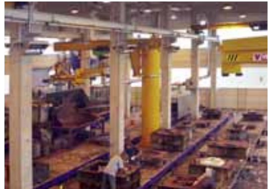
Kaltharz-Formanlage, Formvolumen 2200 x 1600 x 1500 mm
