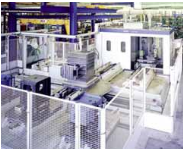
Flexible Fertigungszelle mit Palettenbahnhof. In der eigenen Fertigung werden Bearbeitungszentren von ALZMETALL, GROB, HELLER und STARRAG-HECKERT eingesetzt.
