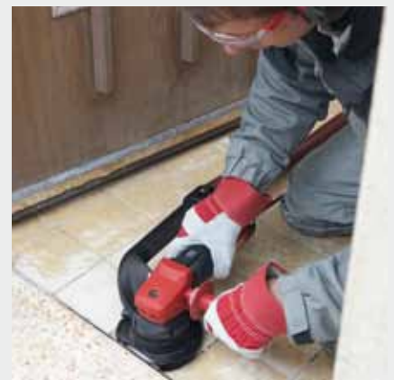
Das werkzeuglos schwenkbare Bürstensegment ist ideal für randnahe Arbeiten.
