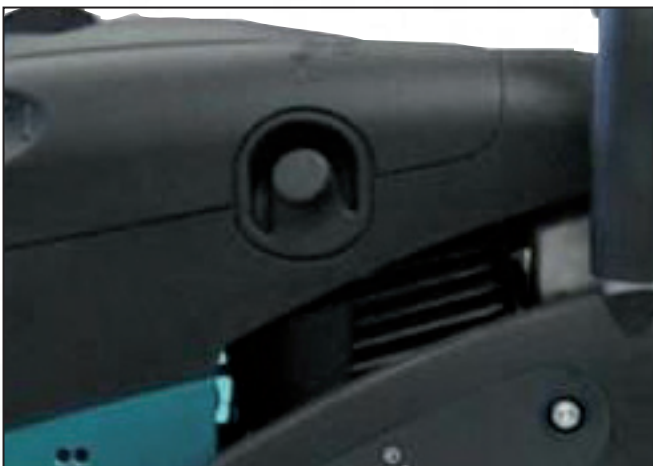
Gut erreichbares Dekompressionsventil zum leichteren Start der Maschine
