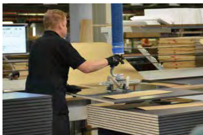
VQL100-35KG Umsetzen von beschichteten Spanplatten
