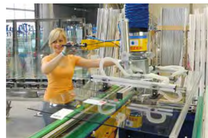
VPL160-90P-35KG mit pneumatischer Schwenkvorrichtung für Glasplatten
