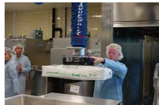
VPL180-60KG in Edelstahlausführung für das Handling von Säcken
