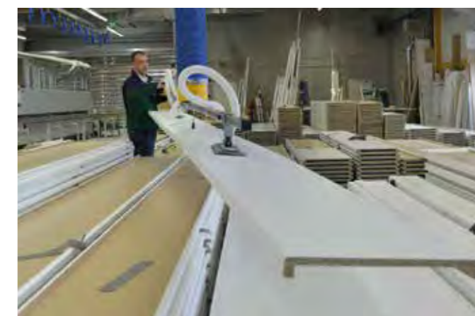
VPL200-125KG Handhabung von beschichteten Spanplatten bis 6.000 mm Länge
