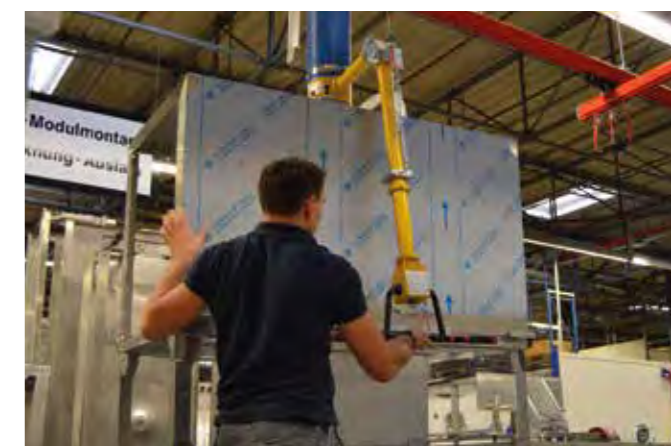
VPL160-60KG mit Bediengelenk und Verlängerung für Blechgehäuse
