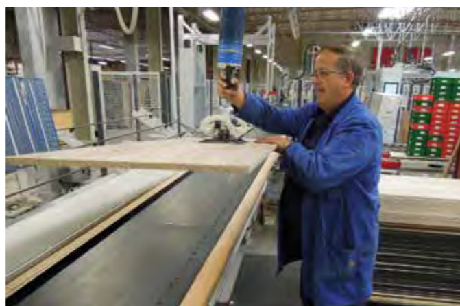
VQL100-35KG Handhabung von rohen, porösen Spanplatten
